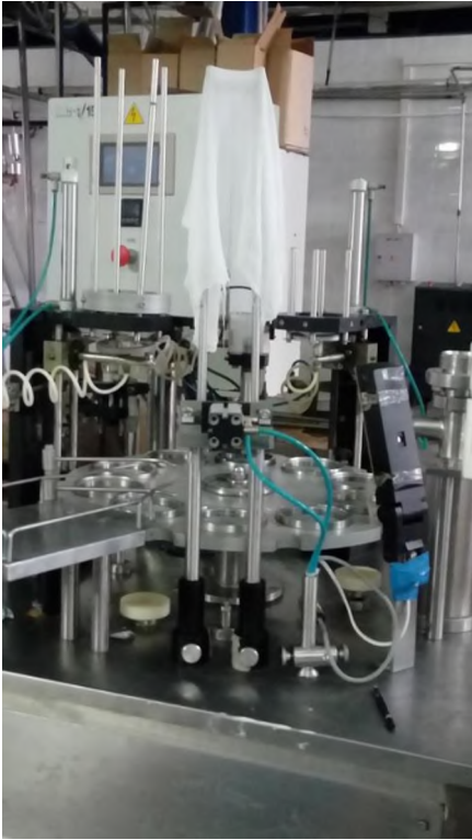
Оборудование для розлива молока
